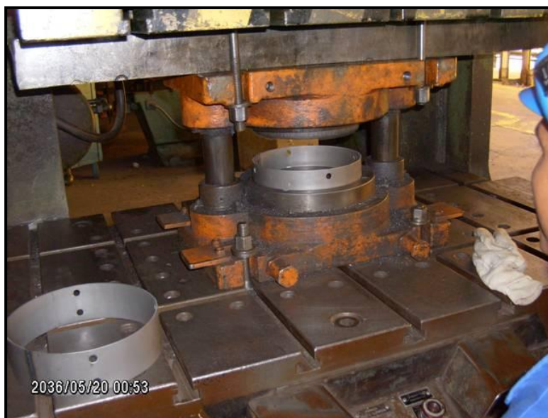
Figura 11.6.- Máquina Rebordeadora de aros
