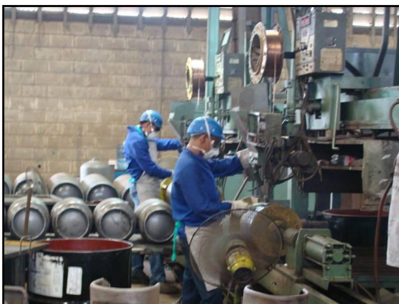
Figura 12.7.- Máquina de Soldadura Radial de cilindros en reparación
