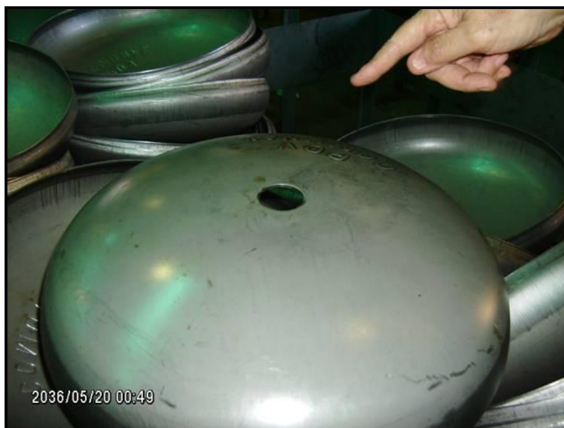
Figura 11.12.- Cabezal con perforación para acople brida
