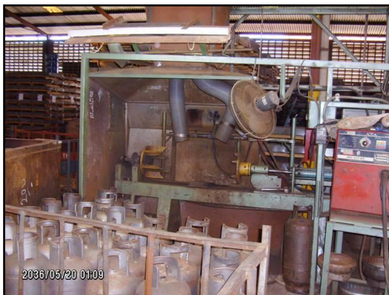
Figura 12.6.- Máquina de Corte de cilindros para reparación
