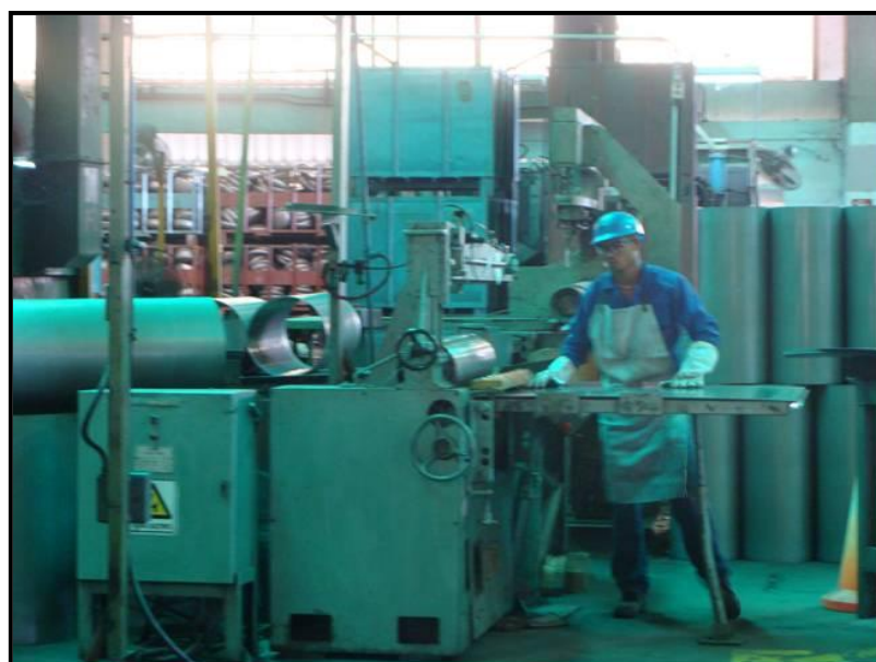
Figura 11.15.- Máquina Roladora de láminas para fabricar el cuerpo del cilindro
