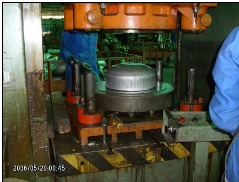
Figura 11.9.- Prensa Embutidora de discos para fabricar fondos
