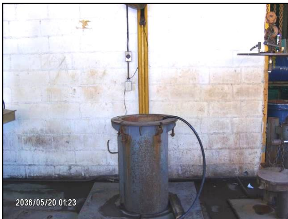
Figura 11.20.- Banco de Prueba de Expansión Volumétrica
