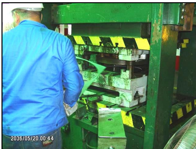
Figura 11.8.- Máquina Cortadora de discos para fabricar fondos
