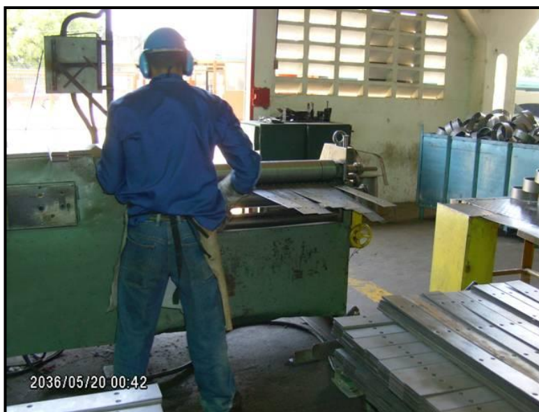
Figura 11.4.- Máquina Roladora de láminas para fabricar aros
