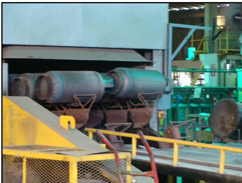
Figura 12.8.- Horno de Alivio Térmico de cilindros en reparación
