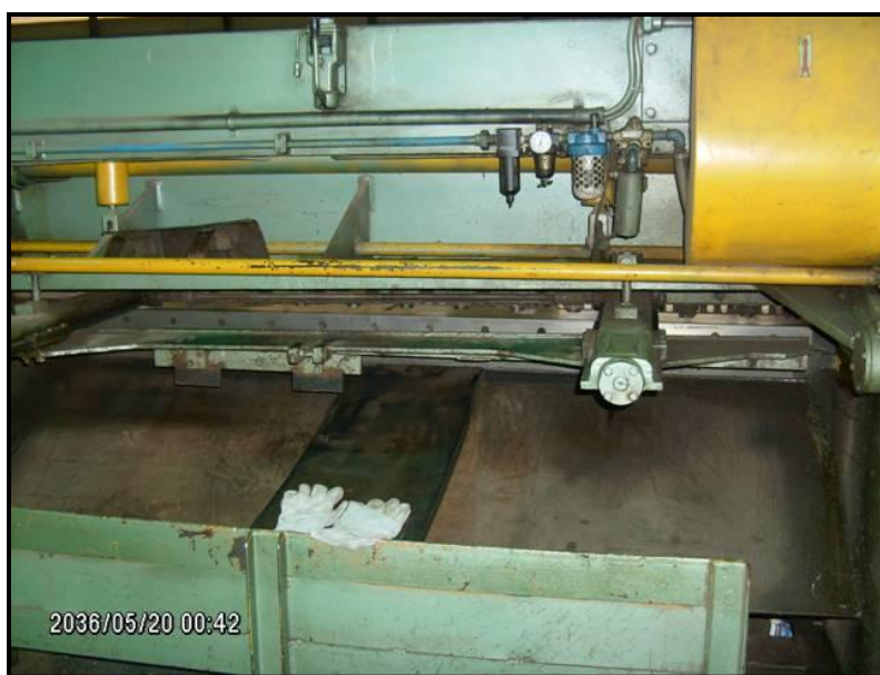
Figura 11.3.- Máquina Perforadora de láminas para fabricar aros
