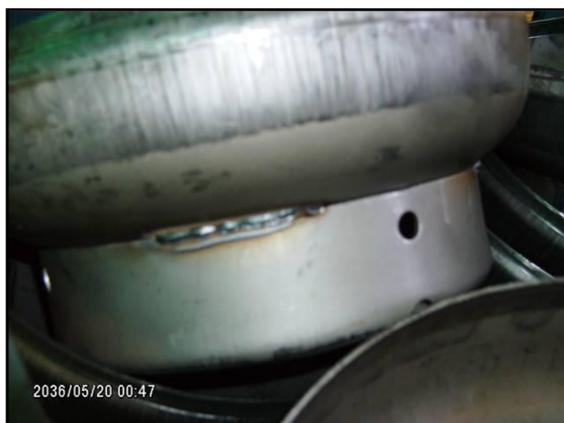
Figura 11.11.- Acople aro – fondo para cilindros
