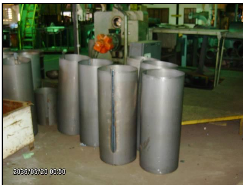
Figura 11.16.- Cuerpo del Cilindro con soldadura longitudinal
