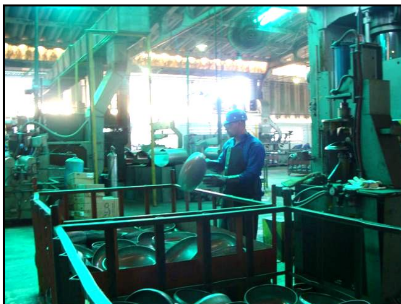
Figura 11.10.- Máquina Rebordeadora de fondos
