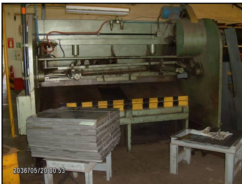
Figura 11.2.- Máquina Cortadora de láminas para fabricar aros
