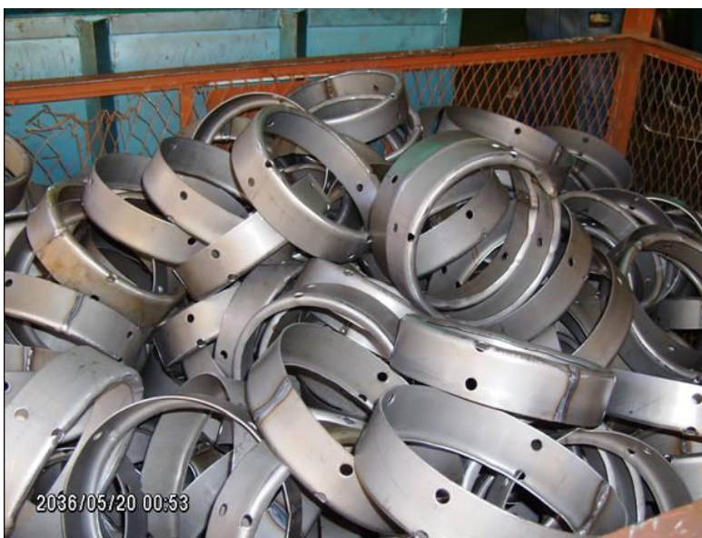
Figura 11.7.- Lote de aros rebordeados para acople con el fondo
