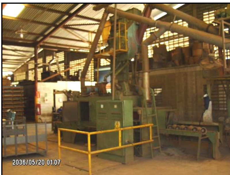
Figura 12.4.- Granalladora para limpieza mecánica de cilindros
